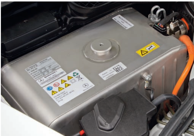
Lithium-Ionen-Batterie im Mercedes S400 Hybrid: „Wir wollen für das jeweilige Fahrzeug die wirtschaftlich und technisch bestmögliche Batterie anbieten oder bauen können“, sagt Dr. Christian Mohrdieck, Leiter des Bereichs Brennstoffzellen- und Batterie-Antriebsentwicklung im Ressort Konzernforschung und Vorentwicklung der Daimler AG.
